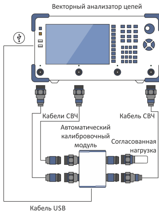
Рисунок 4.23 Схема включения модуля для выполнения полной трехпортовой калибровки на примере портов 1, 2 и 4
